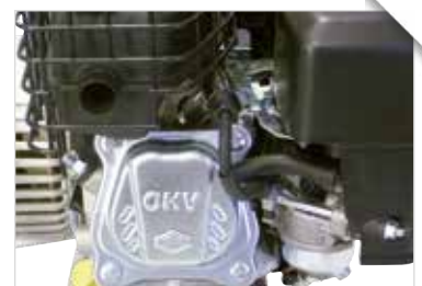
Yläventtiili jolla lankasuojattu äänenvaimennin.
